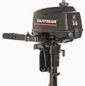
GOLFSTREAM TC3.6 BMS Мощность, л/с – 3,6 Переключение передач – F-N Вес мотора, кг – 13,5 Топливный бак, л – 1,5 Тактность – 2 т ГАРАНТИЯ 3 года.
